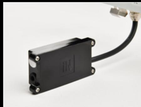
Наружный кожух для электрического соединения из технополимера, подходящий для кабелей Ø6 - 9 мм с резиновой изоляцией. Соединен со светильником кабелем длиной 25 сантиметра.
